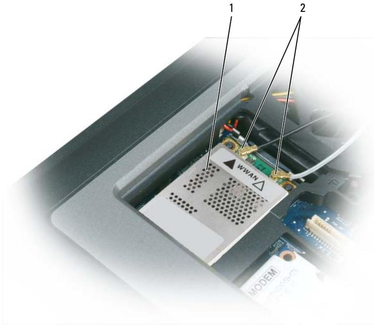
1 Tarjeta de banda ancha móvil 2 cables de antena (2)
