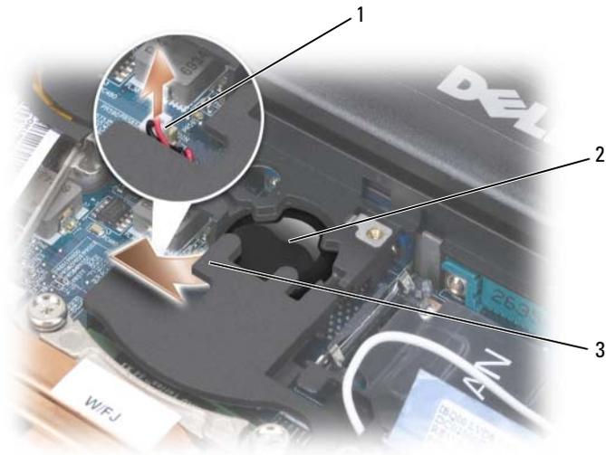
1 Conector de la batería    2 Batería de tipo botón    3 Mylar
