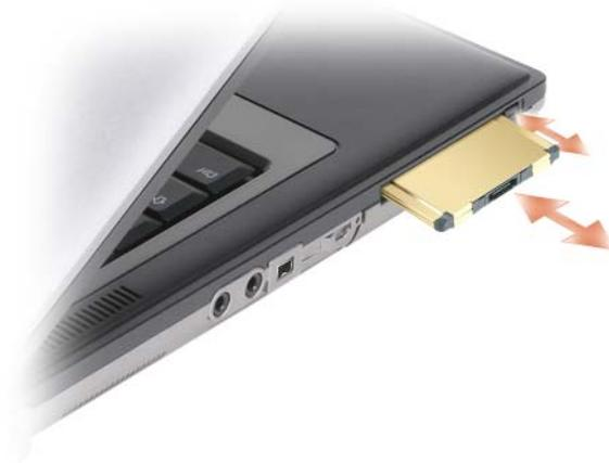
El equipo reconoce la mayoría de las PC Cards y carga automáticamente el controlador de dispositivos adecuado. Si el programa de configuración le pide que cargue los controladores del fabricante, utilice el disco o el CD incluido con la PC Card.
