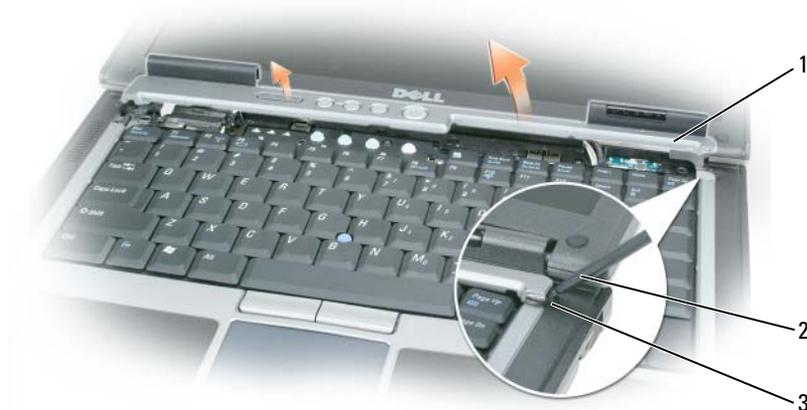
1 Cubierta de las bisagras      2 Punta trazadora de plástico      3 Muesca
